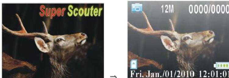
右の画面がテストモードの画面です。各アイコンは、上段左からカメラ/ビデオモード、解像度、撮影枚数と撮影可能枚数、中段左から、SDカードの状態、バッテリー状態、更に下段左から、年月日、時間を表します。
